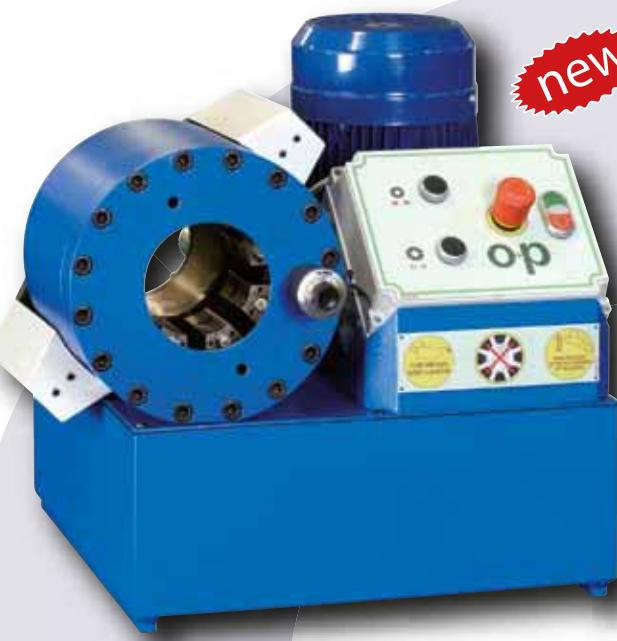
**Tubomatic H83/E EL** - станок для опрессовки рукавов высокого давления до 1" с 6 спиралями и рукавов высокого давления до 1" 1/2 с 4 спиралями
