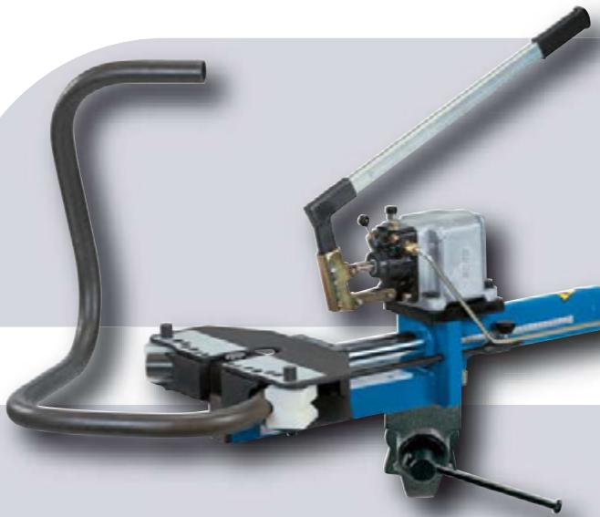
Станок **CM42** был разработан длягики труб от 6 до 42 мм в диаметре с максимальной толщиной стенки 4 мм. Версия CM42 может быть установлена на любую поверхность при условии фиксации штифта. Станок приводится в действие ручным насосом двойного действия.
