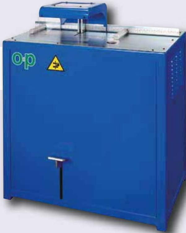
**TF3** подходит для резки гибких гидравлических рукавов до 2" 1/2 с 4 спиральами и до 3" с 2 спиральами
