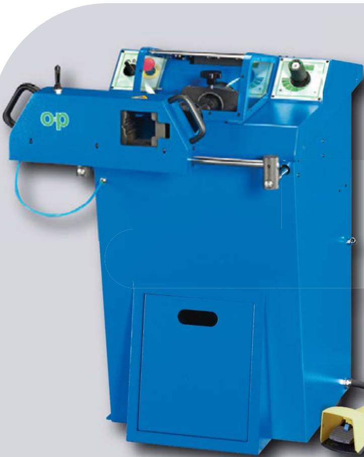
SPF3 позволяет снимать внутренний и наружный слой резины у рукавов высокого давления до 2". SPF3 снабжен неподвижным шпинделем и держателем инструмента с одним резцом, на котором можно установить необходимое расстояние для снятия слоев резины
