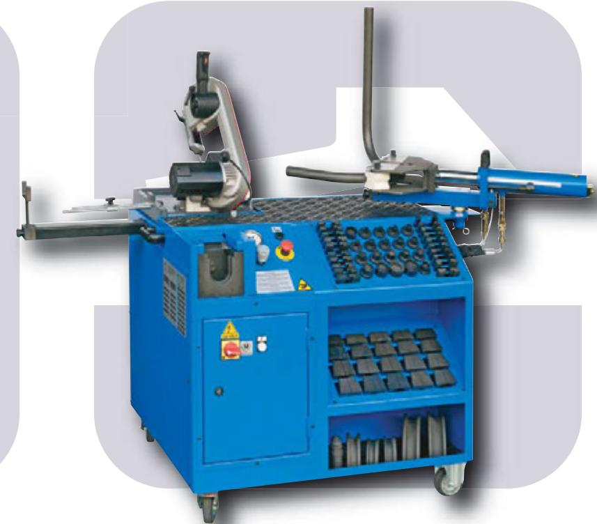
**Center Junior** – это многофункциональное мобильное устройство, позволяющее осуществлять все операции, необходимые для обработки гидравлических труб: резку, внутреннюю и внешнюю зачистку,гибку, монтаж кольца по стандарту DIN 2353, 37° развалцовку труб из нержавеющей (AISI 316TI) и углеродистой стали (ST 37.4) от 6 до 42 мм с толщиной стенки 4 мм с соблюдением стандартов SAE и JIC. Center Junior оснащен компрессором для внутренней очистки труб
