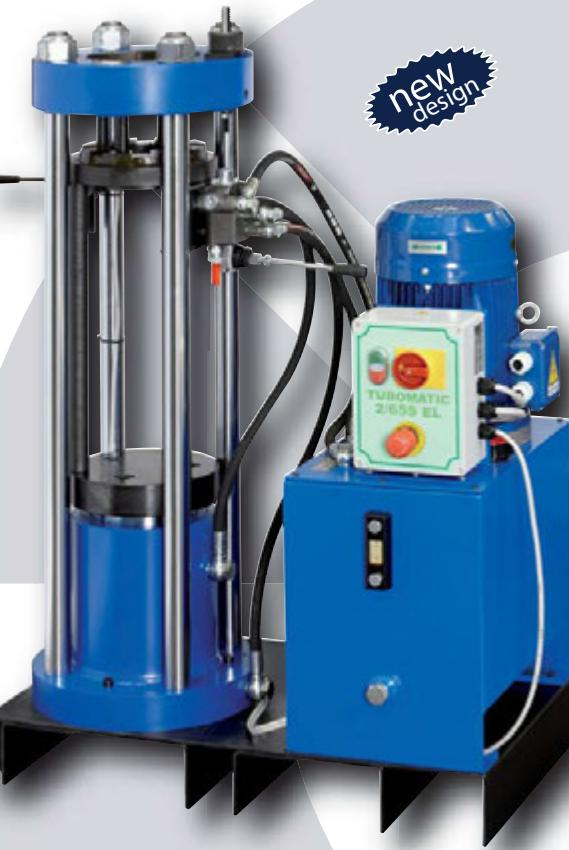
**Tubomatic 2/65 S EL** - станок для опрессовки рукавов высокого давления до 1" 1/2 с 6 спиралями и до 2" с 4 спиральами
