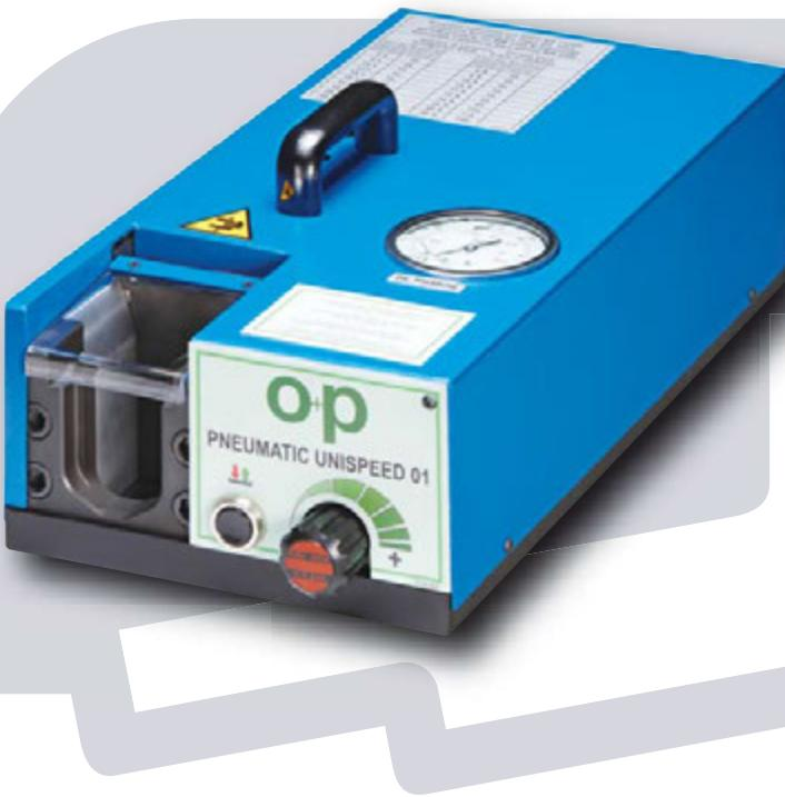
**PNEUMATIC UNISPEED 01** – пневматическое устройство для предварительного монтажа врезного кольца в соответствии со стандартом DIN2353 на трубу из нержавеющей (AISI 316 TI) и углеродистой стали (ST 37.4) от 6 до 42 мм с максимальной толщиной стенки 4 мм
