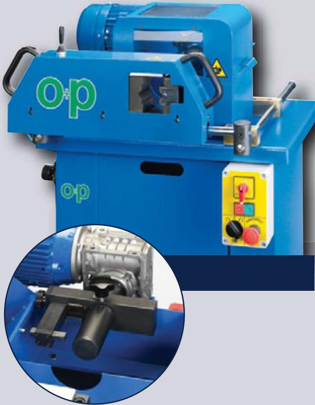
**SPF2** позволяет снимать внутренний и наружный слой резины у гидравлических рукавов до 2". SPF2 снабжен неподвижным шпинделем и держателем инструмента с двойным резцом, на котором можно установить необходимое расстояние для снятия слоев резины. Не требует настройки после каждого снятия резины, что существенно экономит время в работе. Простой и удобный в использовании станок
