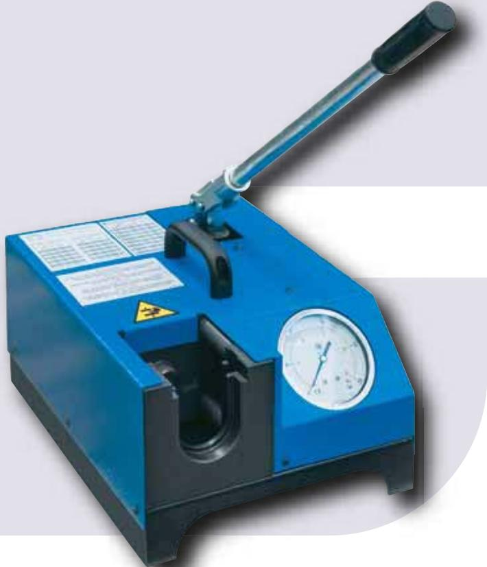
**UNISPEED USFL/01 MAN** – устройство для предварительного монтажа врезного кольца в соответствии со стандартом DIN 2353 на трубу из нержавеющей (AISI 316 TI) и углеродистой стали (ST 37,4) от 6 до 42 мм с максимальной толщиной стенки 4 мм. При необходимости может быть установлен блок для развалызовки труб из нержавеющей (AISI 316 TI) и углеродистой стали (ST 37,4) от 6 до 42 мм с максимальной толщиной стенки 4 мм. Это надежное устройство для мобильной мастерской
