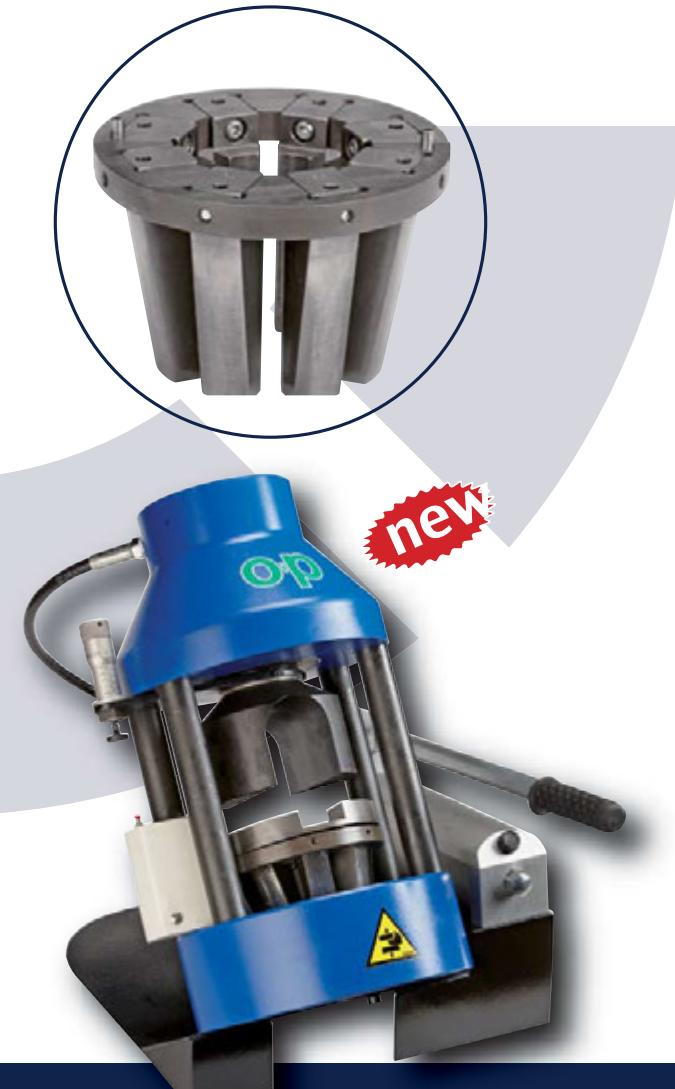
**Tubomatic J67 PM** - станок для опрессовки рукавов высокого давления до 1" 1/4 с 4 спиралью и 1" 1/2 с 2 спиралью, может быть использован в мобильных мастерских
