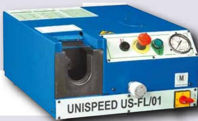
**UNISPEED USFL/01** – устройство для предварительного монтажа врезного кольца в соответствии со стандартом DIN 2353 на трубу из нержавеющей (AISI 316 TI) и углеродистой стали (ST 37,4) от 6 до 42 мм с максимальной толщиной стенки 4 мм. Оснащен ручным регулятором давления. При необходимости может быть установлен блок для развалызовки труб из нержавеющей и углеродистой стали от 6 до 42 мм с максимальной толщиной стенки 4 мм
