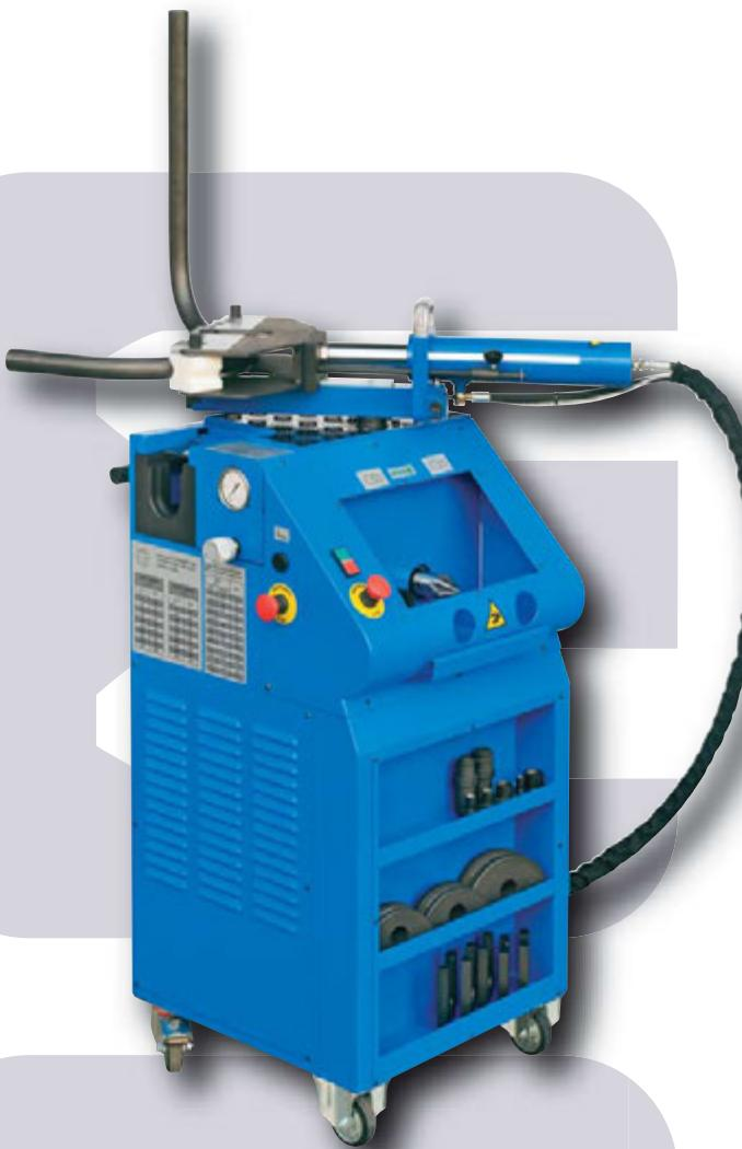
**Mini Center** – небольшое многофункциональное мобильное устройство, позволяющее осуществлять все операции, необходимые для обработки гидравлических труб: внутреннюю и внешнюю зачистку,гибку, монтаж кольца по стандарту DIN 2353, 37° развалцовку труб из нержавеющей (AISI 316TI) и углеродистой стали (ST 37.4) от 6 до 42 мм с толщиной стенки 4 мм с соблюдением стандартов SAE и JIC
