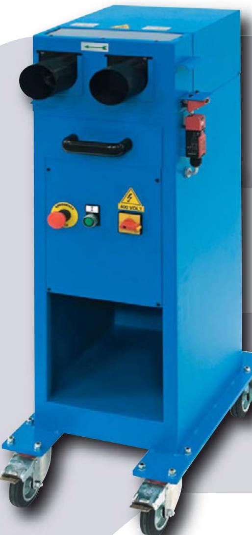
Зачистной станок **S02** выполняет, как внутреннюю, так и внешнюю зачистку концов труб от заусенцев на трубах из нержавеющей (AISI 316 TI) и углеродистой стали (ST 37.4) от 20 до 75 мм, оставляя край трубы чистым и гладким
