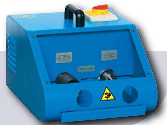
Зачистной станок **S01** выполняет, как внутреннюю, так и внешнюю зачистку концов труб от заусенцев на трубах из нержавеющей (AISI 316 TI) и углеродистой стали (ST 37.4) от 6 до 42 мм с максимальной толщиной стенки 4 мм, оставляя край трубы чистым и гладким
