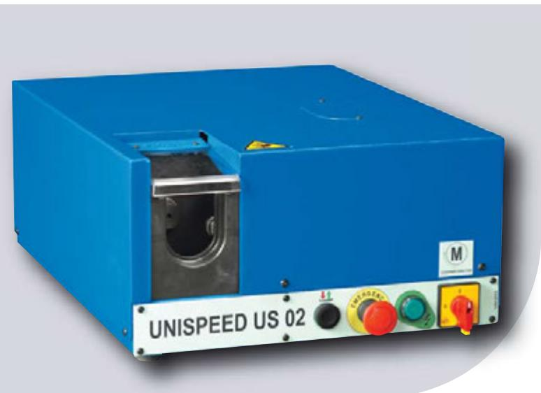
**UNISPEED US 02** использует систему автоматической настройки давления для предварительного монтажа врезного кольца в соответствии со стандартом DIN 2353 на трубу из углеродистой стали от 6 до 42 мм с максимальной толщиной стенки 4 мм
