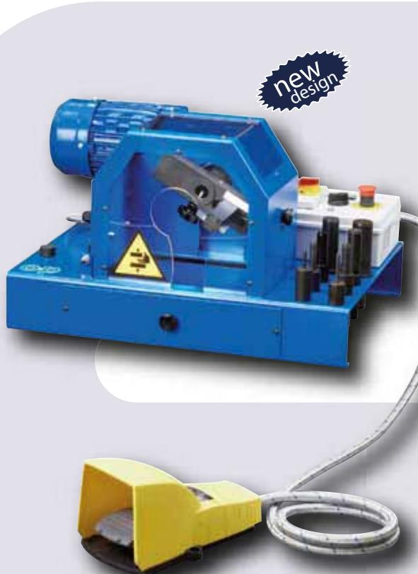
**SPF2/E** позволяет снимать внутренний и наружный слой резины у гидравлических рукавов до 2". SPF2 E снабжен неподвижным шпинделем и держателем инструмента с одним резцом, на котором можно установить необходимое расстояние для снятия слоев резины. Простой и удобный в использовании станок, надежное оборудование для мобильной сервисной службы
