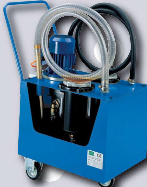
**CF1** - небольшое функциональное устройство предназначено для фильтрации масла перед заправкой станков, гидросистем и других систем, где используются маслянистые жидкости. Постоянное использование фильтровочной машины CF1 предотвращает износ насоса, мотора, цилиндров, клапанов, а также их движущихся частей и уплотнений, таким образом, уменьшая время простоя техники и расходы, связанные с содержанием и потерей производительности
