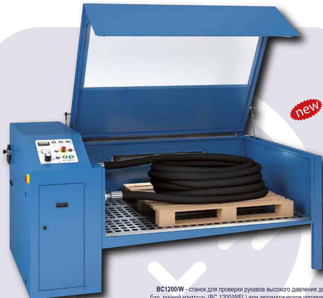
**BC1200/W** - станок для проверки рукавов высокого давления до 1200 бар, ручной контроль (BC 1200/WEL) или автоматическое управление с PLC (BC 1200/WES) и пневмогидравлический насос. Подходит для тестирования рукавов на паллетах
