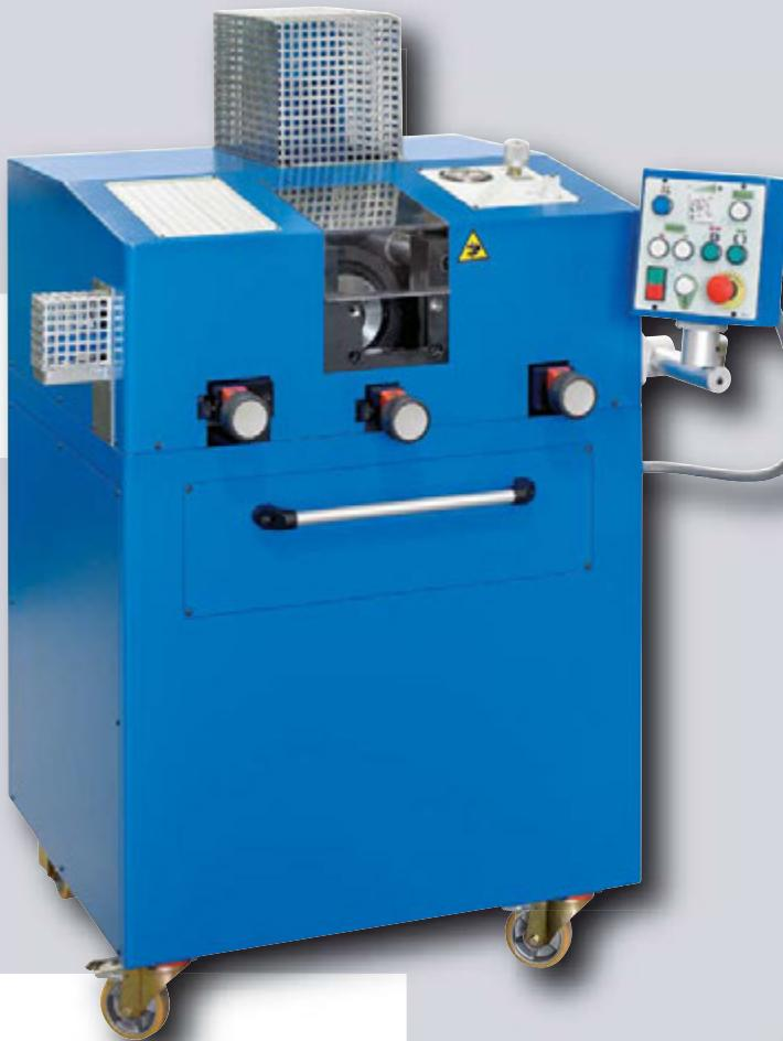
**UNISPEED USFL 90/37** – новая машина для развалцовки гидравлических концов труб на 37° и 90°. Машина требует только одной смены инструмента для проведения развалцовки. Данный станок позволит вам изготовить соединение по типу JIC, ORFS создавая ровную поверхность под прокладку
